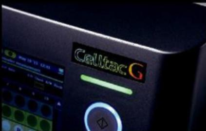
O indicador de estado do Celltac G é localizado no painel frontal e mostra claramente os diferentes estados de operação do analisador. Por exemplo, o operador pode rapidamente reconhecer a necessidade de troca de reagente apenas olhando a mudança do indicador de estado para a cor vermelha.
