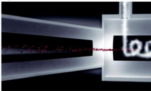
A tecnologia chamada "DynaHelix Flow" alinha perfeitamente as células WBC, RBC e PLT para uma contagem de alta impedância com precisão usando um fluxo hidrodinâmico focado antes de passar pela abertura. Somado a isso, o "DynaHelix Flow" previne totalmente contra o risco de a mesma célula ser contada duas vezes (retorno) usando o exclusivo "DynaHelix Flow stream". Esse avançado sistema recém desenvolvido melhora expressivamente a precisão e confiabilidade das contagens.
