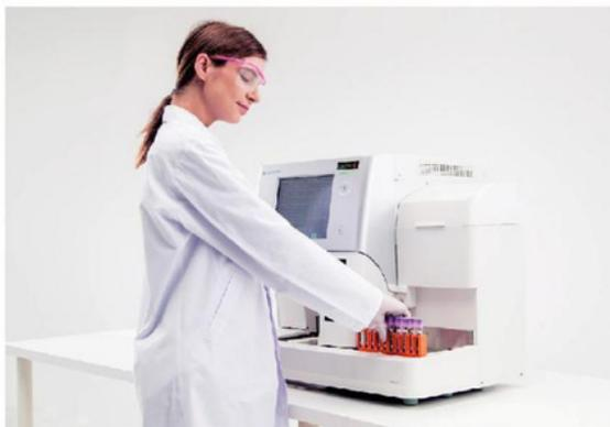
O sistema "inserir e esquecer" de acesso randômico e totalmente automatizado atinge até 90 testes por hora, apenas inserindo os racks no carregador.
