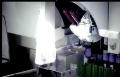
Cada tubo é coletado do rack colorido e suavemente homogeneizado por um braço homogeneizador interno. O carregamento automático contribui para um resultado de amostra muito mais rápido, para uma tomada de decisão clínica e melhora a eficiência do fluxo de trabalho.
